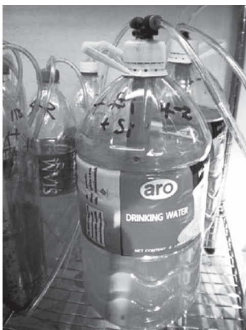
ภาพที่ 1 แสดงระบบไบโอรีแอคเตอร์ที่ผลิตจากขวดพลาสติก
