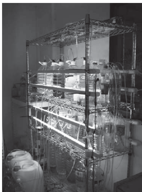
ภาพที่ 1 แสดงระบบไบโอรีแอคเตอร์ที่ผลิตจากขวดพลาสติก
