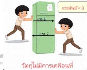
ภาพที่ 2.9 : แสดงการออกแรง 2 แรง เท่ากันในทิศทางตรงข้ามกัน
