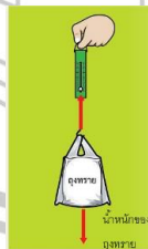
ภาพที่ 2.10 : แสดงการใช้เครื่องชั่งสปริงวัดค่าของแรง
