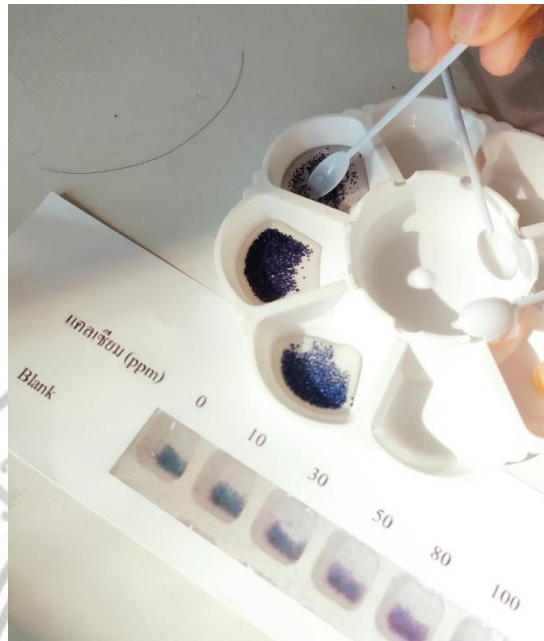
ภาพที่ ค-9 : การทดสอบน้ำกระด้างโดยใช้ชุดทดสอบที่สร้างขึ้นเองของนักเรียนชั้นมัธยมศึกษาปีที่ 4/1
