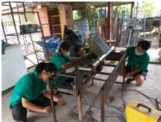
ภาพที่ 9-10 แสดงการขัดสนิมเหล็กทำความสะอาด
