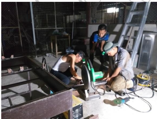
ภาพที่ 1-2 แสดงการตัดเหล็กกลมและตัดเป็นช่องสี่เหลี่ยม
