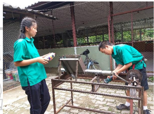
ภาพที่ 9-10 แสดงการขัดสนิมเหล็กทำความสะอาด
