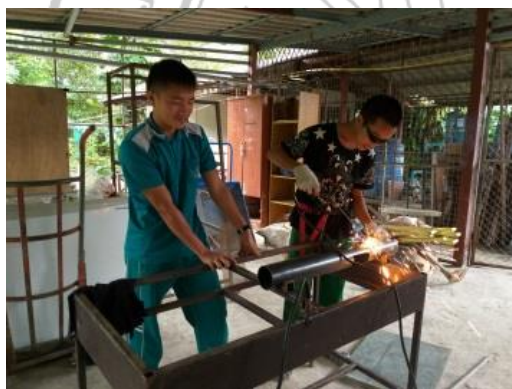
ภาพที่ 5-6 แสดงการเชื่อมท่อเหล็กกลมติดกับโครงเหล็ก
