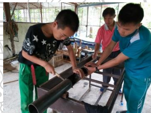
ภาพที่ 5-6 แสดงการเชื่อมท่อเหล็กกลมติดกับโครงเหล็ก
