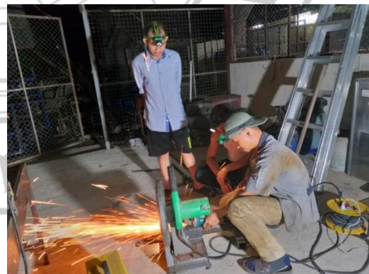
ภาพที่ 1-2 แสดงการตัดเหล็กกลมและตัดเป็นช่องสี่เหลี่ยม
