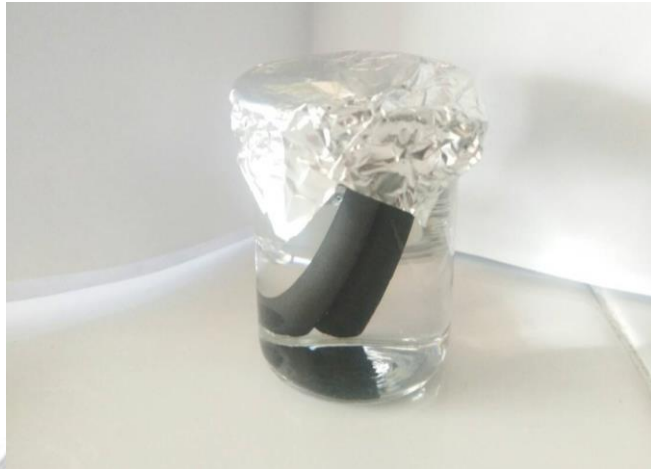
ภาพที่ 3.3 นำแท่งแกรไฟต์ แช่ในสารละลายอะซิโตน
