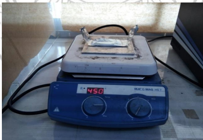
ภาพที่ 3.5 นำแท่งแกรไฟต์ไปอบความร้อนด้วยเครื่อง Hotplate ที่อุณหภูมิ 450 องศา
