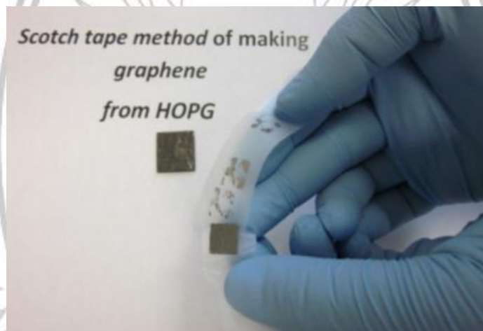
ภาพที่ 2.5 การลอกชั้นของแกรฟีนออกจากชั้นของ Highly Oriented Pyrolytic Graphite (HOPG) โดยใช้สก๊อตเทป
