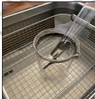
ภาพที่ 3.3 ทำความสะอาดลวดด้วยเครื่องทำความสะอาดความถี่สูง
