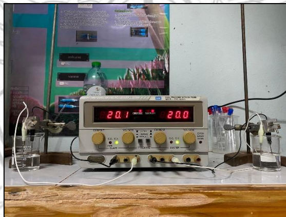
ภาพที่ 3.5 การสังเคราะห์ไทเทเนียมไดออกไซด์ควอนตัมดอทด้วยวิธีไฟฟ้าเคมี
