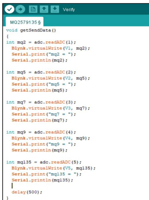
ภาพ 6 คำสั่งการเชื่อมต่ออุปกรณ์เซนเซอร์ MQ2, MQ5, MQ7, MQ9 และ MQ135 ให้แสดงผลบนแอปพลิเคชัน Blynk
