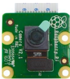
ภาพ 5 Raspberry Pi Camera V2
