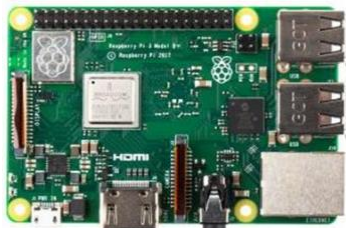
ภาพ 4 Raspberry Pi 3 Model B
