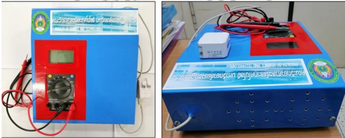
ภาพที่ 3.27 เครื่องมือวัดค่าทางไฟฟ้าแบบแสดงผลด้วยเสียงพูด
