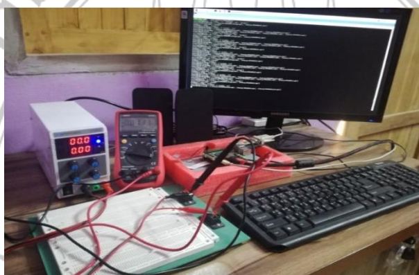
ภาพที่ 3.11 การต่ออุปกรณ์วัดแรงดันไฟฟ้ากระแสตรง ที่มา: นิเทศ ประเดชญญ
