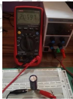
ภาพที่ 3.17 การวัดตัวเก็บประจุขนาด 2200uF
