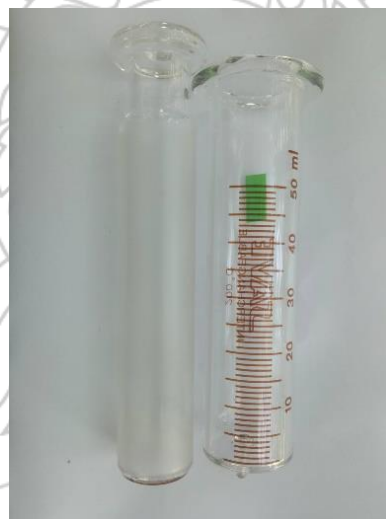
ภาพกระบอกฉีดยาแก้ว ขนาด 50 mL สำหรับวัดปริมาตรก๊าซชีวภาพรายวัน
