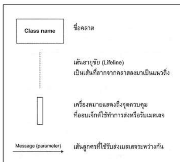
ภาพที่ 2.2 สัญลักษณ์ Sequence Diagram (โอภาส เอี่ยมสิริวงศ์, 2555)
