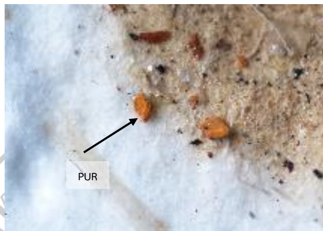
ภาพที่ 4.3 วัตถุ Polyurethane, PUR ที่พบบริเวณสถานีสูบน้ำแรงดันต่ำบ้านท่อ
