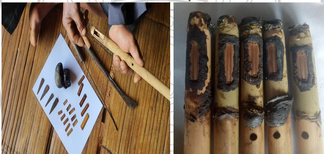
ภาพที่ 13-14 การใส่ลึนปีกับท่อเสียงไม้ไผ่ ปิดด้วยชันรงค์เชื่อมกันให้สนิททุกท่อ
