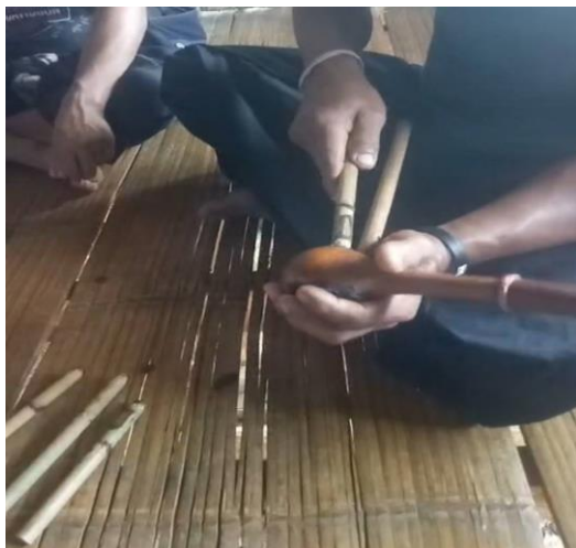
ภาพที่ 15-16 การประกอบท่อนเสียงไม้ไผ่ เข้ากับลูกน้ำเต้าปิดด้วยซี่ชันรงค์(ซี่มัน)
