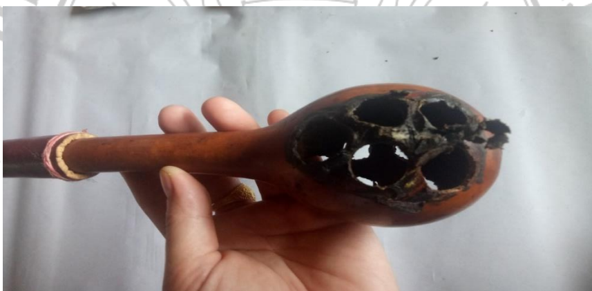
ภาพที่ 4.15 การเจาะรูเพื่อใส่ท่อเสียงบนลูกน้ำเต้า 5 รู ทะลุบนล่าง
