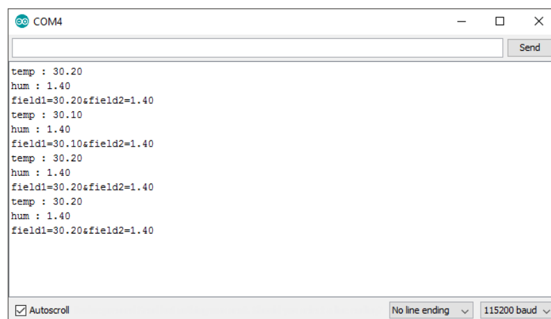
ภาพที่ 4.8 การเช็คค่า Temperature และ Humidity จาก Serial Monitor
