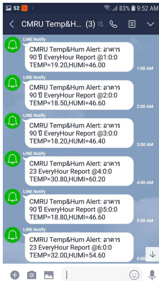
ภาพที่ 4.16 ตัวอย่างแสดงการแจ้งเตือน ค่าอุณหภูมิและความชื้นผ่าน Line notify
