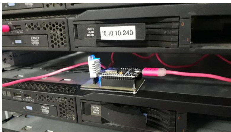
ภาพที่ 4.1 การเชื่อมต่อ ESP8266 เซนเซอร์วัดอุณหภูมิ DHT22
