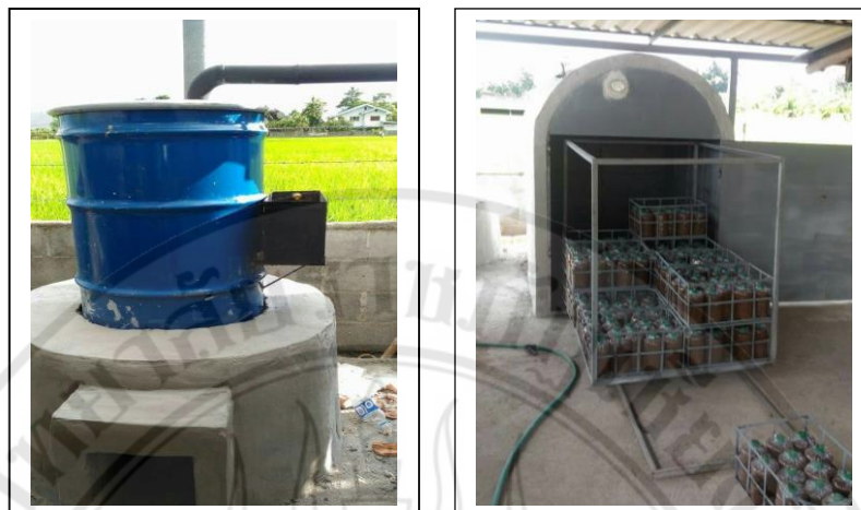
ภาพที่ 4.7 แสดงการปรับปรุงระบบนึ่งก้อนเชื้อเห็ดนางฟ้าจากชีวมวลเพื่อถ่ายทอดให้ชุมชนอื่น
