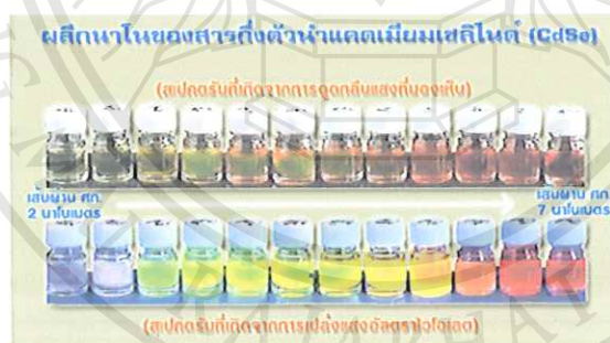
ภาพที่ 2.6 ผลึกนาโนของสารกึ่งตัวนำแคดเมียมเซเลไนด์ (CdSe) ที่มีสีที่ต่างกัน ออกไปตามขนาดเกรนของผลึก
