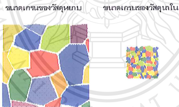
ภาพที่ 2.9 แสดงลักษณะเกรนของวัสดุแบบก้อนใหญ่เปรียบเทียบกับเกรนของวัสดุนาโน ที่มา : http://www.rmutphysics.com/charud/oldnews/67/index67.htm
