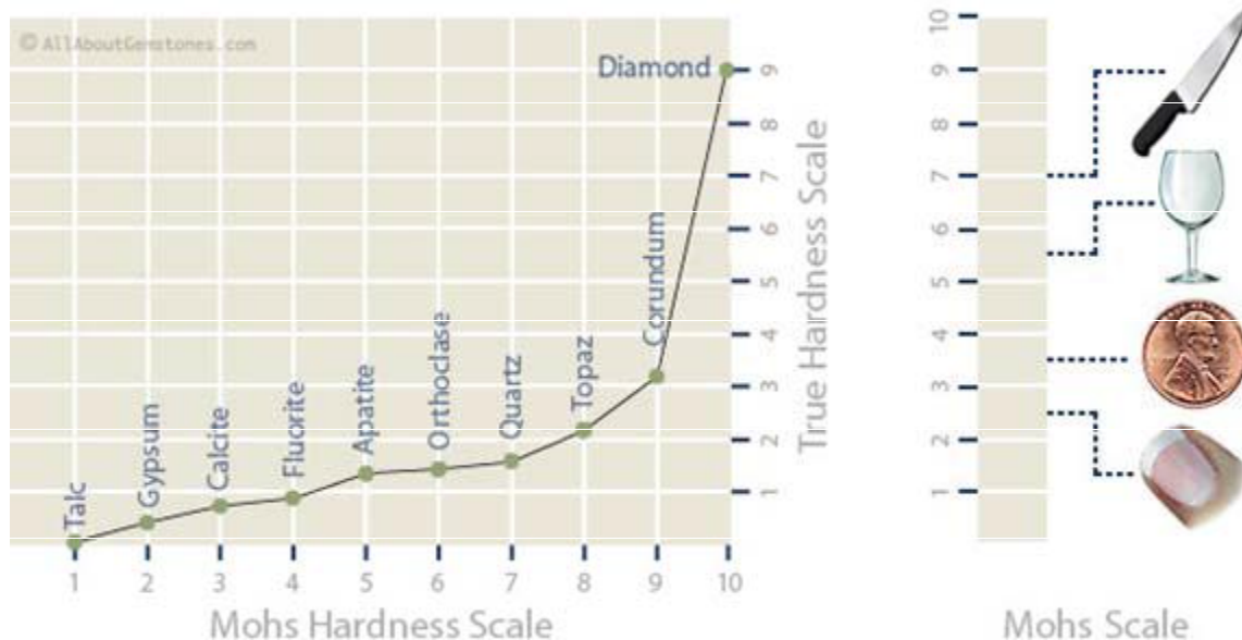
รูปที่ 2.8 ลำดับความแข็งของวัสดุตามสเกล Mohs
